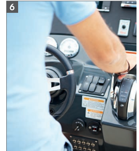
6 Ergonomischer Steuerstand mit Instrumentierung, optionaler 9" Simrad Chartplotter, VesselView und SmartCraft Instrumentierung
