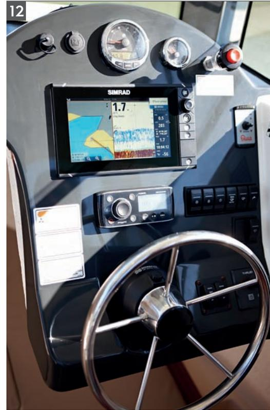
Integrierter Steuerstand mit Hydrauliklenkung, SmartCraft Instrumentierung und optional 9" GPS und Bluetooth Radio
