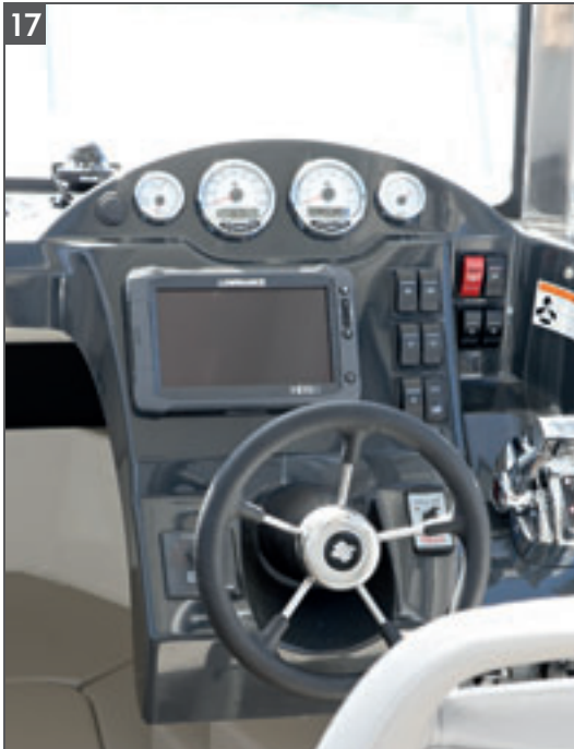
Integrierter Steuerstand mit hydraulischer Lenkung, SmartCraft Instrumentierung, Platz für optionales 9" GPS/Echolot
