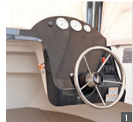
Ergonomischer Steuerstand mit Drehzahlmesser und Geschwindigkeitsanzeige sowie 12V-Anschluss serienmäßig am Armaturenbrett. Optionales Elektronikpaket beinhaltet GPS/Echolot/Stereoanlage
