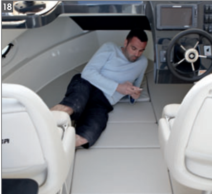
Integrierter Steuerstand mit hydraulischer Lenkung, SmartCraft Instrumentierung, Platz für optionales 9" GPS/Echolot
